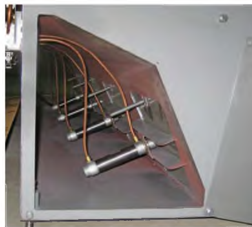
Пневмоцилиндры SMC (Япония) обвязываются только медными трубками
