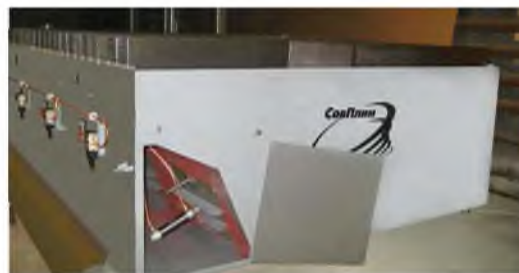
Модуль МВС со снятой заглушкой воздушного канала и без кожуха пневмораспределителей
